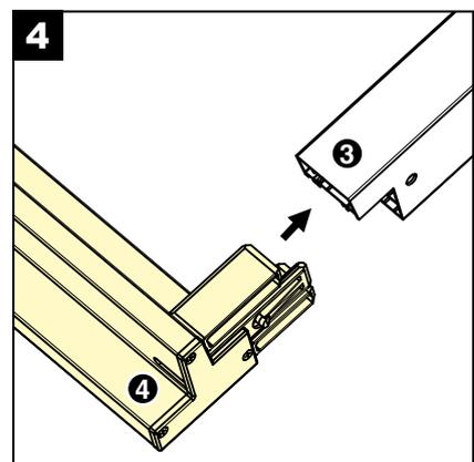
Auf richtige Ausrichtung der Führungs-Schienen achten. Abgestuftes Ende 2 3 unten zur Verschlussleiste.
