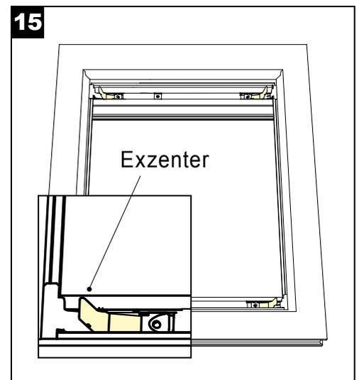
**ACHTUNG:** Bei offenen Kniehebeln kann das BLINOS ROLLO aus dem Fenster fallen! BLINOS Rahmen solange festhalten, bis die beiden Kniehebel geschlossen sind!
